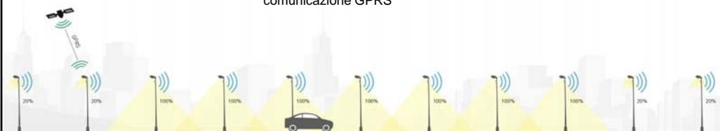
Il radar rileva veicoli che si avvicinano (fino a una velocità di 200 km/h) e trasmette un segnale alle lampade vicine per fare incrementare il flusso luminoso. Il numero delle lampade attivate e la durata dell'attivazione sono parametrabili.
