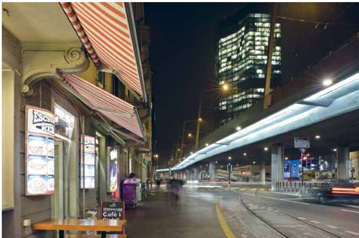
3. Vista notturna delle strisce luminose LED collocate al di sotto del Hardbrücke di Zurigo. Foto Juliet Haller, Amt für Städtebau, per gentile concessione di «Faktor», n. 41, p.17
